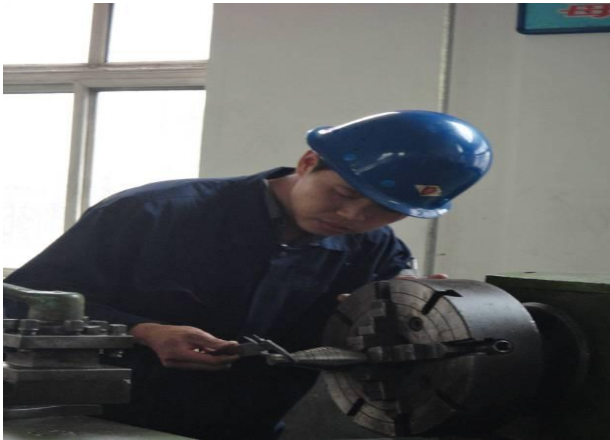
安琪老师参加岗位技能培训，加工阶梯轴件照片
